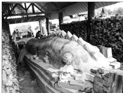
実験用穴窯(上部から見下ろしたところ) Oxford
